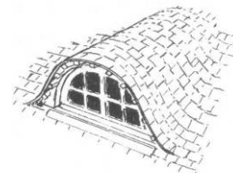
lucarne à jouées galbées (couverture ardoise ou chaume)
