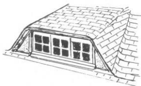
lucarne en trapèze (couverture en bardeaux d'asphalte)
